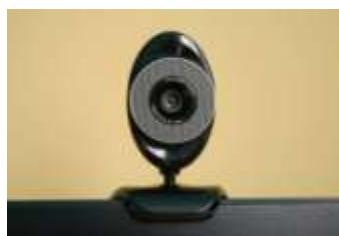
Webcam fungsinya tak jauh beda dari kamera digital. Webcam adalah kamera yang terhubung ke web, bisa untuk melakukan panggilan video (video call) dan berfoto. Biasanya input device ini terpasang pada komputer dan diletakkan di atas monitor. Bentuk webcam mini seperti kamera CCTV dan dapat merekam jika diaktifkan.
