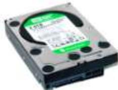
Hardisk adalah perangkat keras yang digunakan untuk menyimpan data pada komputer. Semua data yang ada dalam komputer baik itu dokumen, gambar, data sistem, OS, aplikasi akan tersimpan dalam perangkat ini. Hard Disk Drive (HDD) atau biasa kita sebut hardisk menyediakan ruang khusus untuk menyimpan dan membaca data. Perangkat ini bersifat *non-volatile memory* yang berarti data yang kita simpan tidak akan hilang meskipun komputer dimatikan.
